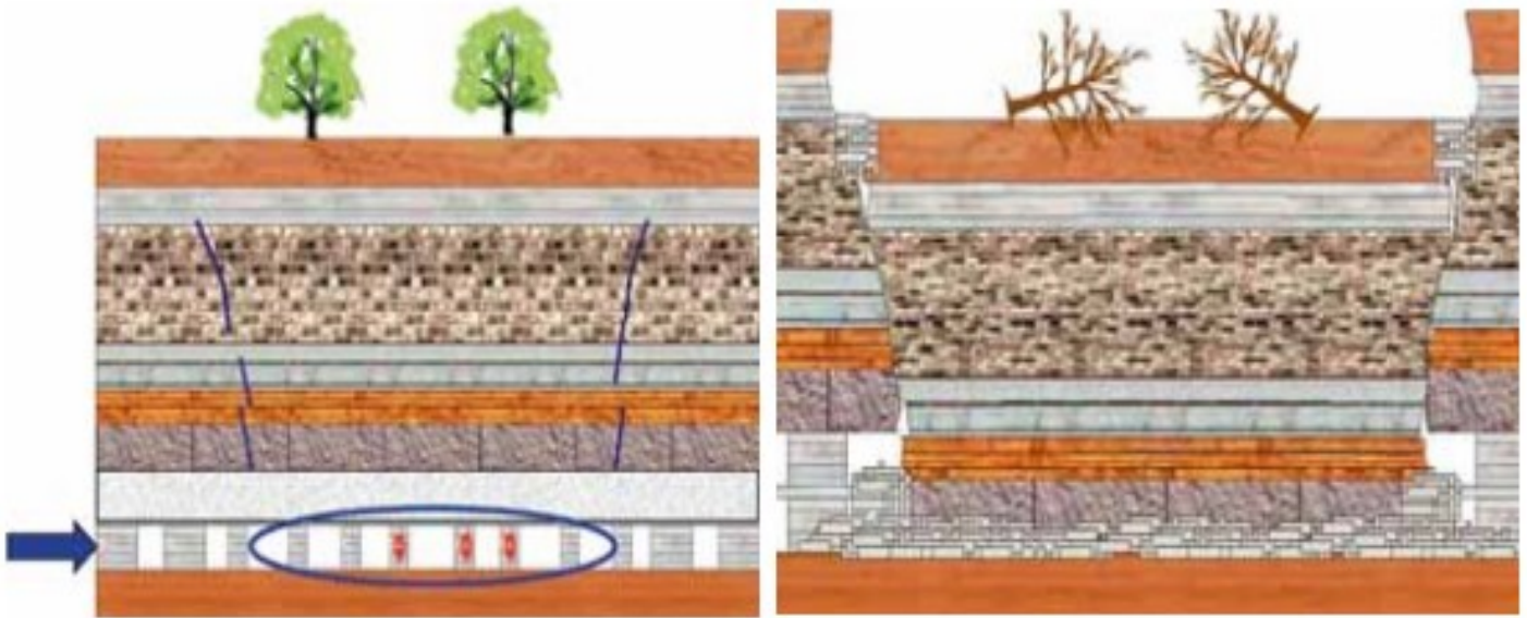
Illustration 15 : schéma d'un effondrement généralisé - source : MEDDE / DGPR.
