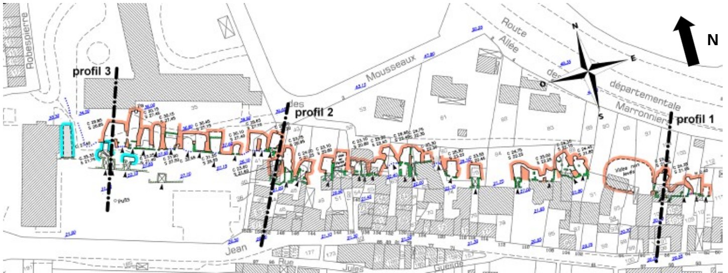
Illustration 6 : caves en bord de Seine (source : atlas des carrières souterraines des Yvelines – IGC).
