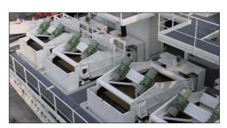
Dessablage par cyclones  $\emptyset$ 250 mm (avec  $d_{50}$  = 20  $\mu$ m avec eau et 30 – 40  $\mu$ m avec boue selon la viscosité) capable de faire une coupure  $d_{95}$  à 63  $\mu$ m
