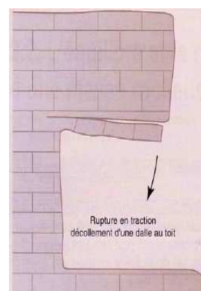
Illustration 2 : schéma de principe des différents types de rupture (basculement, rupture de pied, rupture de surplomb)
