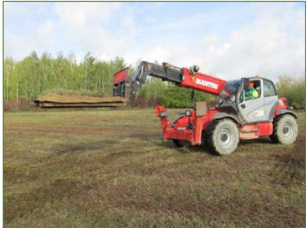
Reprise des plaques et transport pour mise en place sur la zone d'accueil
